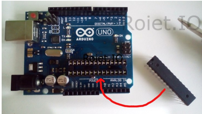
รูป Arduino Board รุ่น UNO เรานำไมโครคอนโทรลเลอร์ รุ่น ATmega 328P เสียบใส่ช่อง เพื่ออัปโหลดโปรแกรม
