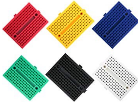
บอร์ดทดลอง ใช้ต่อวงจรต้นแบบ (Breadboard)
