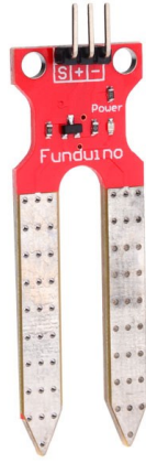
เซนเซอร์วัดความชื้นในดิน (Soil moisture sensor)
